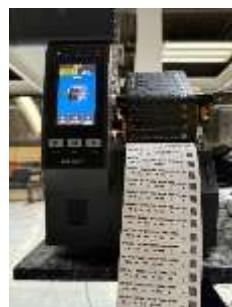
Nota: Máquina utilizada para impresión de etiquetas que contiene clave, descripción, medidas, metraje y folio del material.
